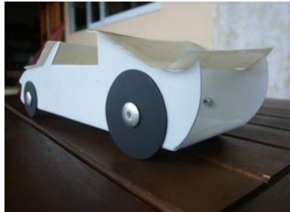
Le projet met en pratique diverses méthodes utilisées dans le métier de la carrosserie, Traçage, lecture de plan, cisailage, sciage, burinage, formage du spoiler avant, bord plié pare choc arrière, ... préparation peinture, peinture, utilisation des matériaux composites, assemblage par rivetage, ...
